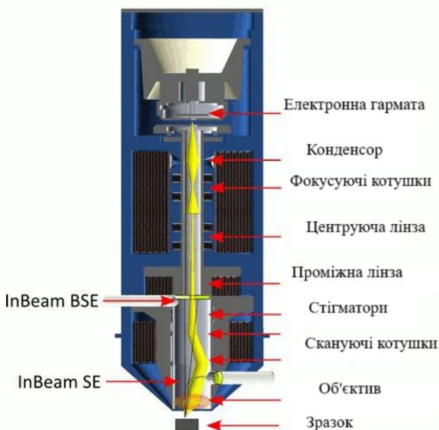
Рис.17. Принципова схема скануючого електронного мікроскопа (CEM)
