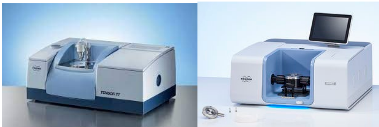
Рис.11 FTIR спектрометри Tensor 27 (Bruker) та Bruker INVENIO-R з Bio-ATR приставкою
