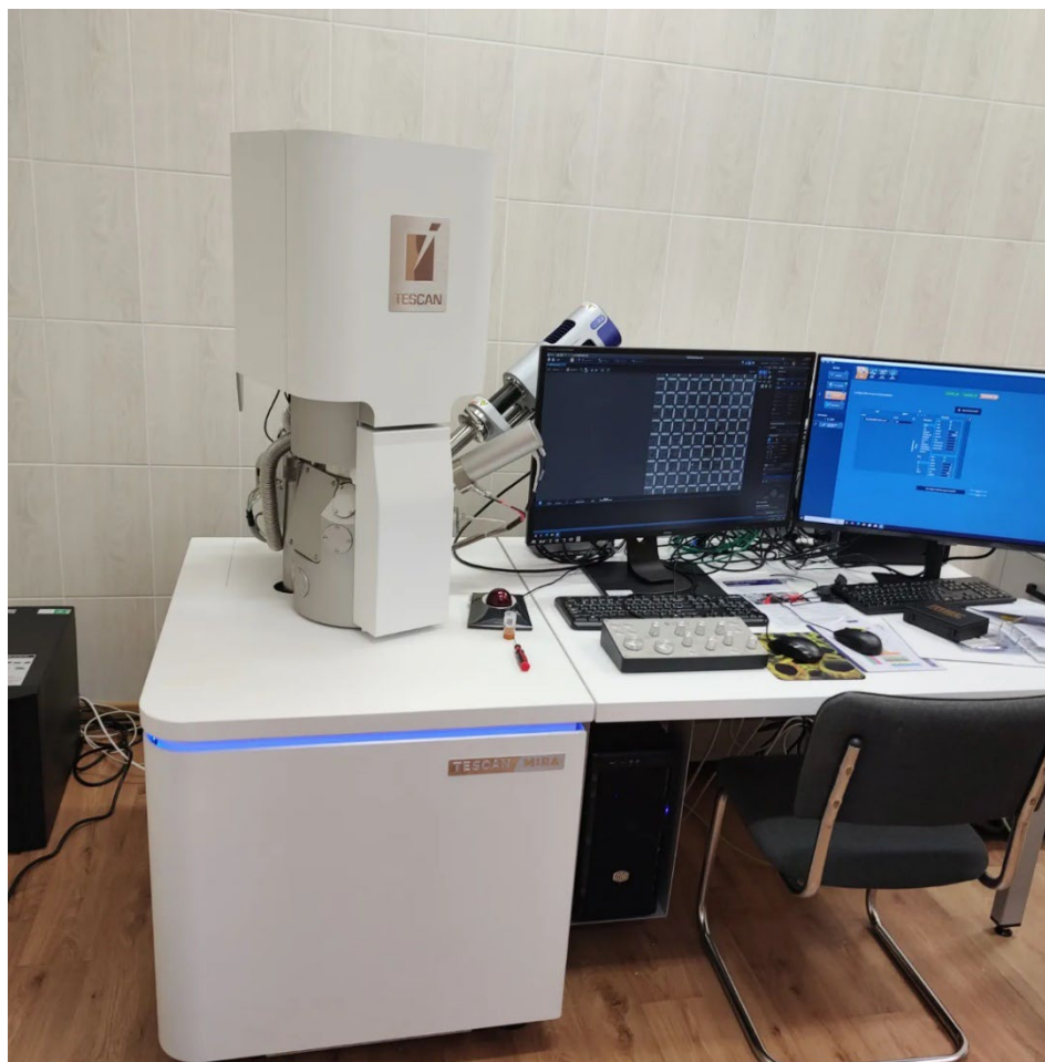
Рис.19. Процес налаштування розмірних сіток в системі СЕМ з польовою емісією, та встановлення EDS детектора, у виконанні автора.
